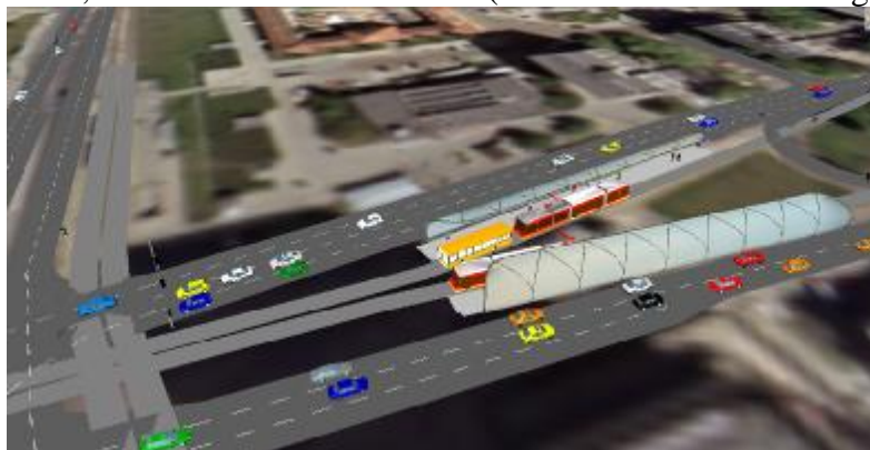
Rys. 3. Wizualizacja wykonana w programie VISSIM - przystanek tramwajowo-autobusowy Metro Ratusz-Arsenał (Plac Bankowy).
