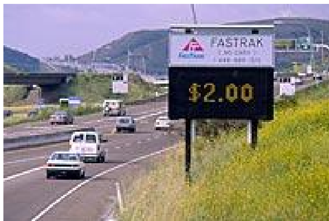
Fot. 2 Znak o zmiennej treści informujący o bieżącej wysokości opłat za przejazd ekspresowymi pasami ruchu. Źródło: www.sandag.cog.ca.us
