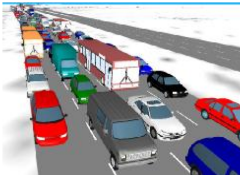
Rys. 2. Ul. Modlińska w rejonie EC Żerań – symulacja ruchu przed wprowadzeniem pasa autobusowego - wizualizacja 3D w programie VISSIM
