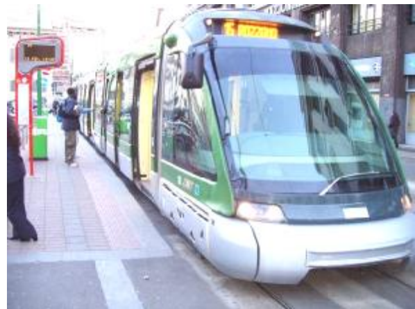
Fot. 4 Mediolan – przykład nowoczesnego, niskopodłogowego i jednoprzestrzennego tramwaju.
